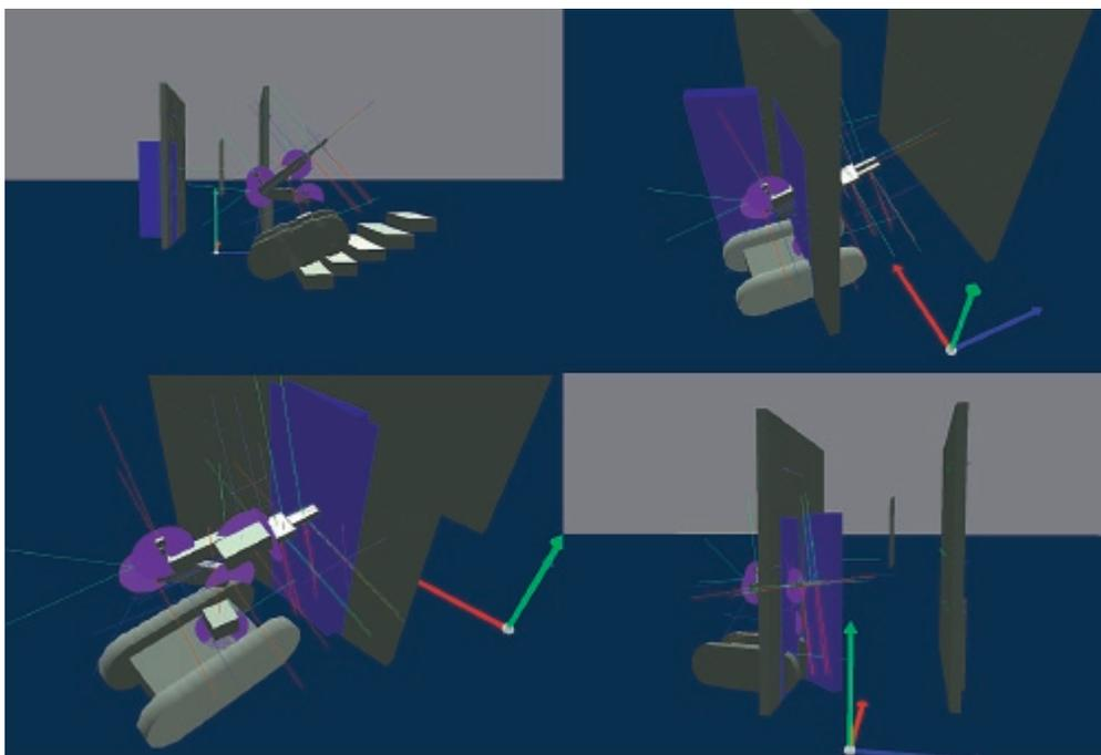
Fig. 7. Robot simulator semantic events. Rys. 7. Semantyczne zdarzenia w symulatorze robota
