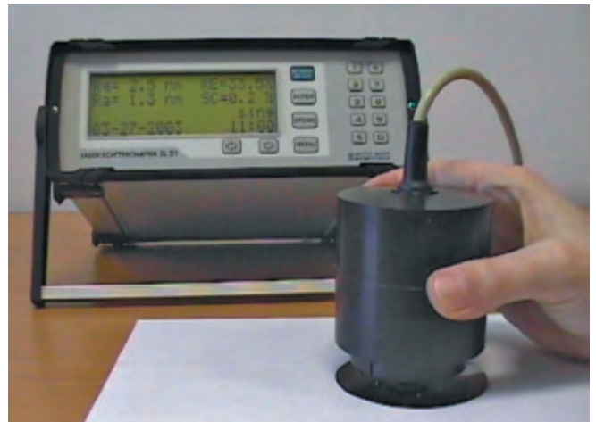
Rys. 7. Skaterometr SL 31 opracowany w Instytucie Maszyn Matematycznych
