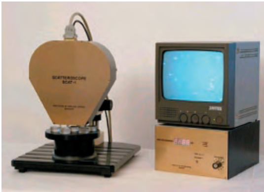
Rys. 8. Skateroskop opracowany w Instytucie Optyki Fig. 8. Scatteroscope developed in Institute of Applied Optics
