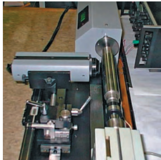
Rys. 9. Stanowisko do badania powierzchni metali za pomocą pomiaru rozkładu światła rozproszonego wykonane w Politechnice Koszalińskiej Fig. 9. Stand for investigation of metal surfaces with measurement of scattered light layout
