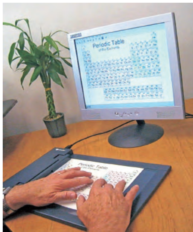
Rys. 4. System IVEO SVG Viewer (View Plus Inc): Tablet dotykowy z nakładką będącą wypukłą kopią wyświetlanej grafiki na ekranie komputera PC służąca do znajdowania miejsc w grafice, po naciśnięciu których użytkownik usłyszy ich objaśnienia Źródło: [8]
