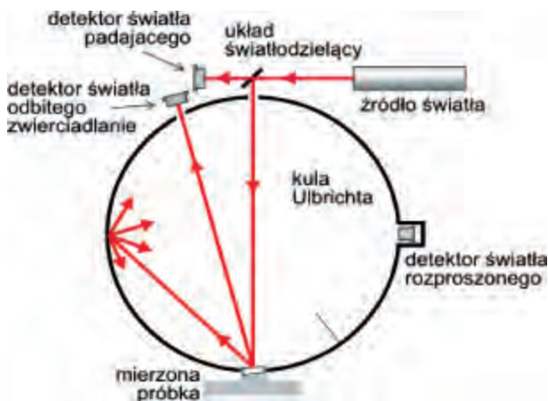
Rys. 1. Układ do pomiaru parametru TIS z kulą Ulbrichta Fig. 1. Unit for measuring TIS parameter with the Ulbricht sphere
