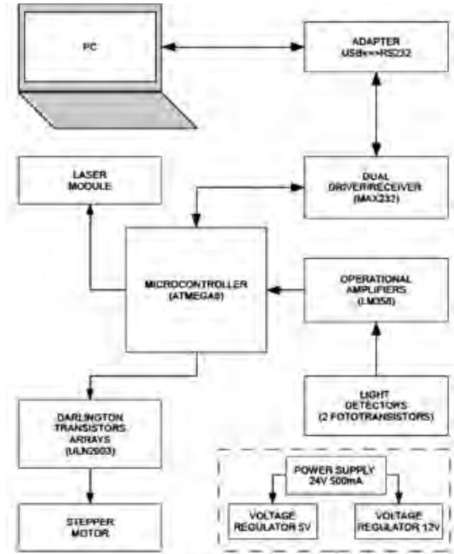
Rys. 5. Schemat blokowy urządzenia. Fig. 5. Device block diagram
