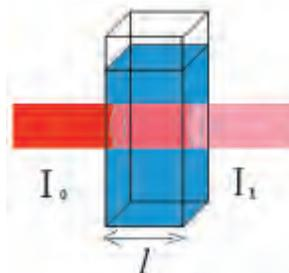
Rys. 1. Schemat absorpcji światła ( $I_0$  – natężenie wiązki wchodzącej do ośrodka,  $I_1$  – natężenie wiązki przepuszczonej,  $l$  – droga pokonana przez światło w obiekcie)
