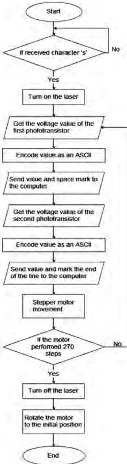
Rys. 7. Schemat blokowy algorytmu. Fig. 7. Flowchart of the algorithm
