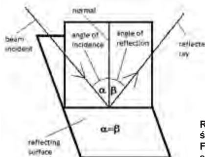
Rys. 2. Schemat odbicia światła
