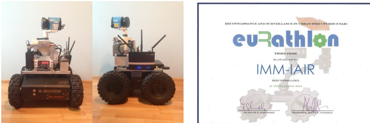
Rysunek 1. Robot mobilny z kamerą CCD oraz laserowym system pomiarowym 3D przygotowany do zadań USAR
