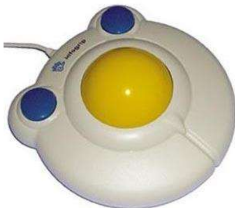
Rysunek 4. BIG Track - specjalistyczna mysz komputerowa z dużymi trackballem oraz przyciskami
