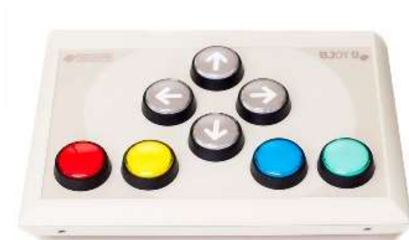
Rysunek 5. BJoy Button - specjalistyczna mysz komputerowa, z 8 klawiszami, z których każdy odpowiada innym funkcjom standardowej myszki
