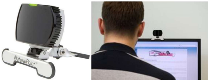
Rysunek 8. SmartNav AT - urządzenie zastępujące klasyczną mysz - kamera obserwująca ruch kropki umieszczonej na czole użytkownika
